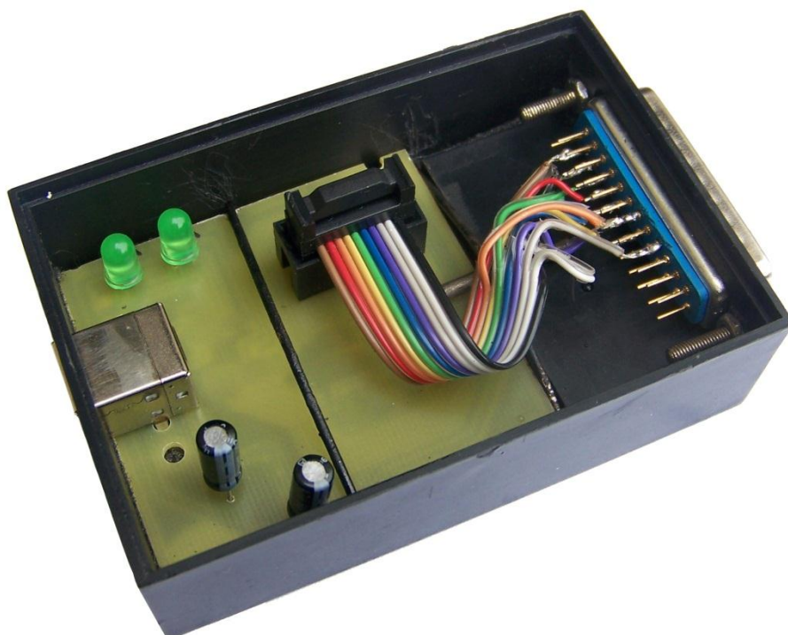
Obr. 7.5: Fotografie komunikačního rozhraní - vnitřní zapojení DSP
